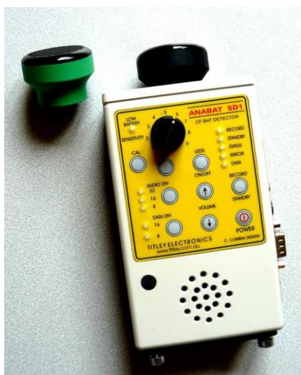
Détecteur à ultra-sons, modèle ANABAT SD1 « Titley electronics » - Photo Cédric LOUVET
