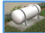
Ancrage de la cuve
