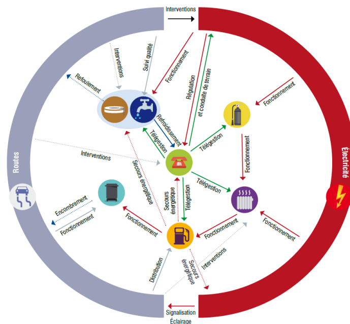
Figure 8 - Schéma des interdépendances entre réseaux (Cepri, 2016 17 )
